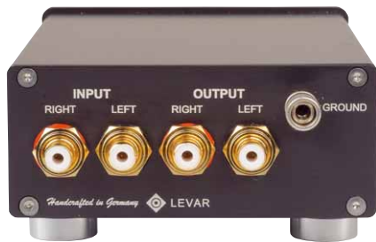
Zwei rein, zwei raus – das Anschlussfeld des Übertragers
