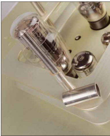
Schlauchstücke beruhigen die einzelnen Lagen der „Blechpakettürme“
