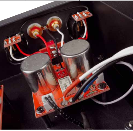
Die beiden Übertrager sorgen für die symmetrischen Ausgangssignale
