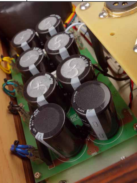
In Sachen Siebkapazität herrscht kein Mangel bei diesem Gerät
