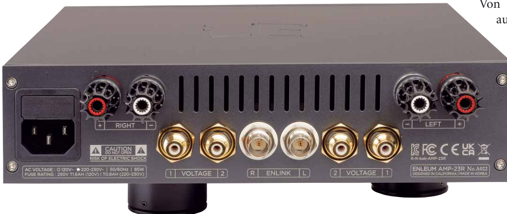
Zwei klassische und ein spezieller Eingang müssen reichen in Sachen Anschlussvielfalt
