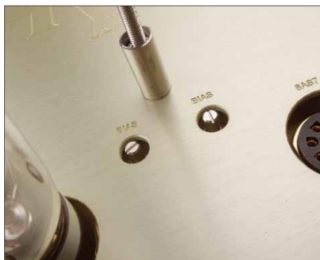
Der Ruhestrom der Endstufen wird mit zwei Potis auf dem Treiberblock eingestellt
