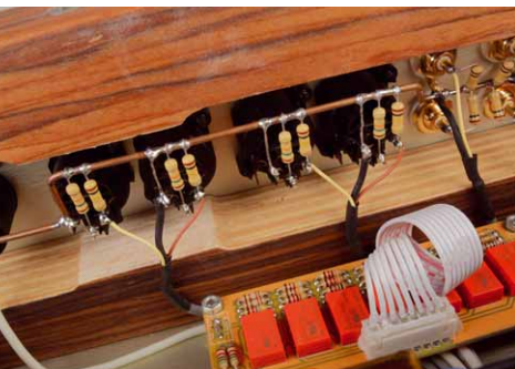
Die XLR-Eingänge sind nicht nur Dekoration, sondern echt symmetrisch verschaltet
